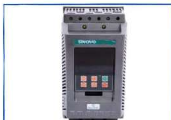
Soft Starter Modelo: SFT30-011-C Tensão: 380Vac Potência: 11Kw (15cv) Corrente: 23A
