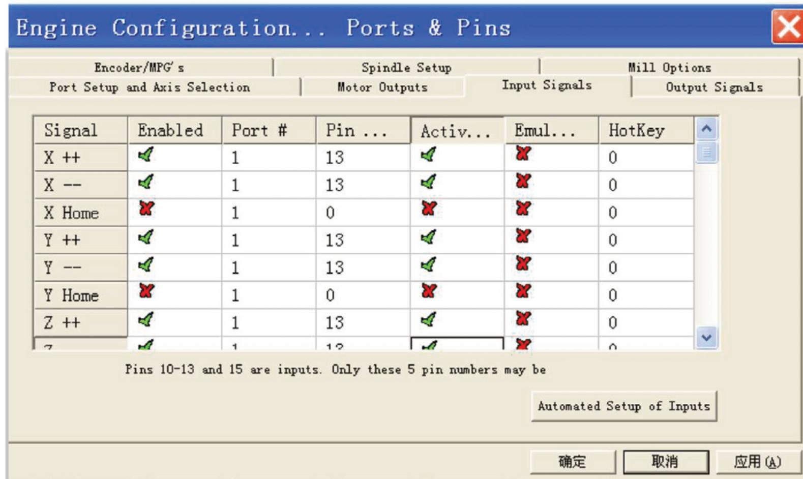
2) Os sensores de ferramenta e home devem ser controlados por outras portas de entrada individuais. Usando sensor de ferramenta, a máquina só irá habilitar quando uma ferramenta for conectada.
